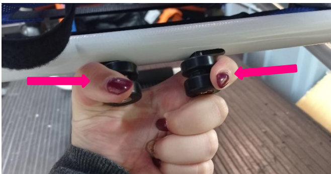
Kuva 2 – Selkänojan kallistuksen säätökahvat.
