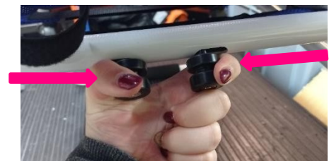
Kuva 2 – Selkänojan kallistuksen säätöviput.
