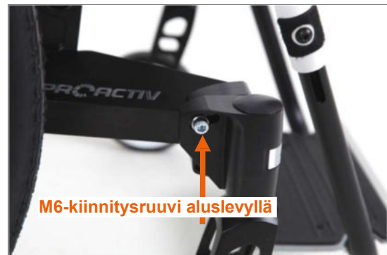
Kuva 82: M6-kiinnitysruuvi rungon ulkopuolella aluslevyn kanssa
