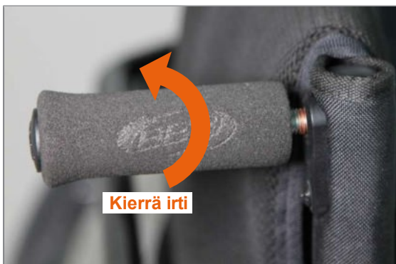
Kuva 140: Kierrä työntökahva vaakasuoraan ulos takaputkesta
