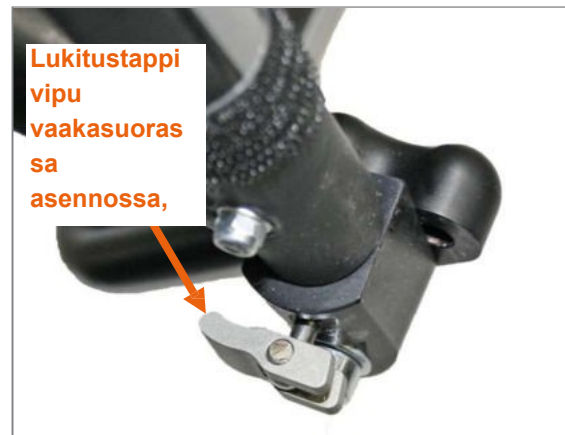
Kuva 88: Lukitustappivipu vaakasuorassa asennossa, ei lukittu eikä siten kosketa jalkatuen liitosta
