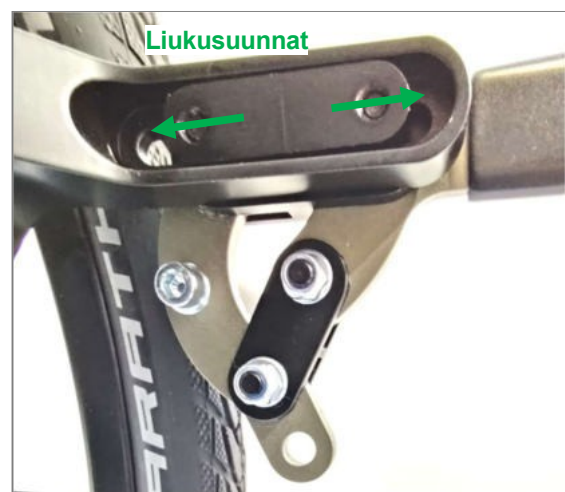
Kuva 121: Liukusuunnat (LIFT aktivoitu; näkymä pyörätuolin sisäpuolelta)
