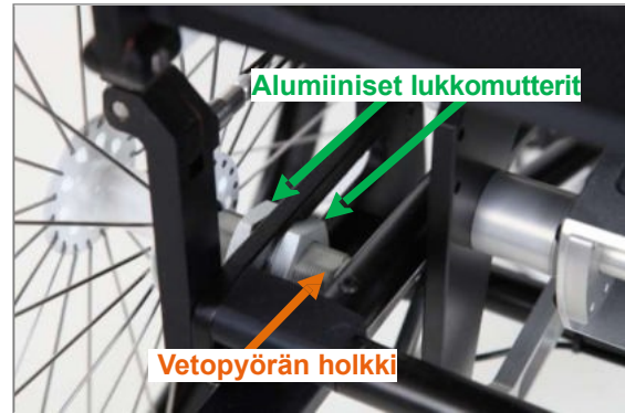
Kuva 57: Vetopyörän holkki ja alumiininen lukkomutteri (näkyvä takaa; LIFT kiinteä)
