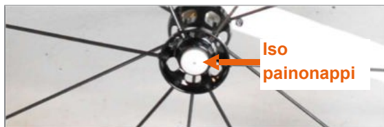
Kuva 52: Pikavapautusakseli, jossa on käyttötuki ja suuri painonappi
