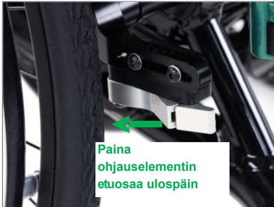
Kuva 132: Integroitu jarru auki, sulkeminen tapahtuu painamalla ohjauselementtiä ulospäin
