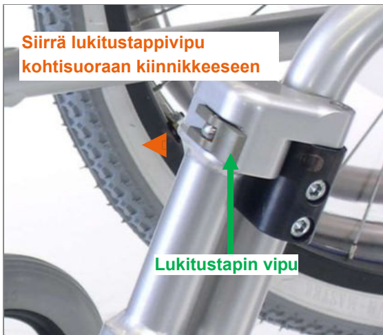
Kuva 103: Käännä lukitustappivipua kohtisuoraan, jotta kääntyvä jalkatuki voidaan irrottaa
