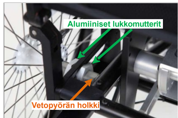
Kuva 6: Vetopyörän holkki ja alumiininen lukkomutteri (takakuva)
