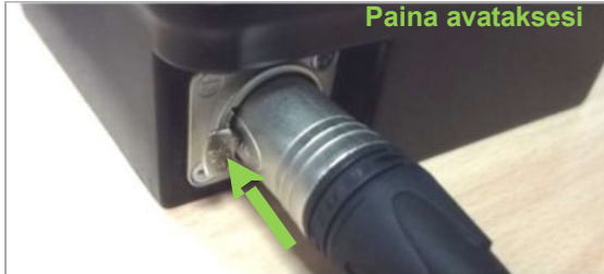
Kuva 157: Laturin pistokkeen lukituksen avaaminen
