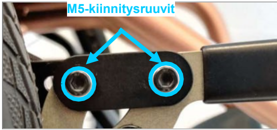
Kuva 122: M5-kiinnitysruuvit jarrunpitokiskossa (asennettu etuosaan); LIFT activ
