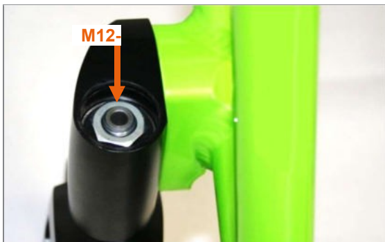
Kuva 75: Alumiinikorkki irrotettuna ja M12-mutteri näkyvissä
