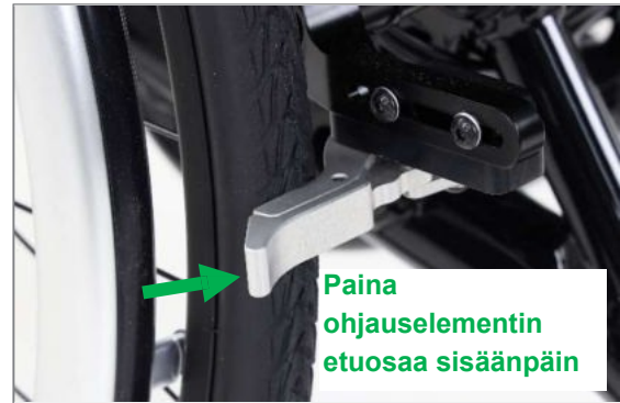
Kuva 134: Integroitu jarru suljettuna, jarru avataan painamalla ohjauselementtiä pyörätuolin keskustaa kohti
