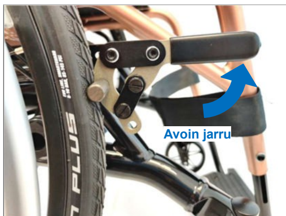
Kuva 120: Jarru kiinni; avataan vetämällä jarruvipua ylöspäin ja taaksepäin
