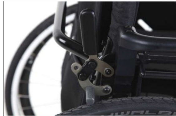
Kuva 128: Takana asennettu polvivivujarru (sivulta katsottuna)
