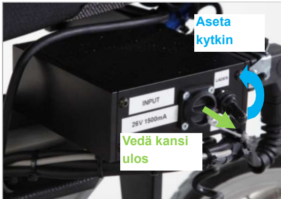
Kuva 158: Valmistautuminen lataamiseen pyörätuolin takaosassa
