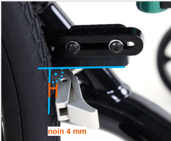
Kuva 136: Jarruelementti integroidun jarrun oikean asemoinnin jälkeen
