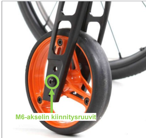
Kuva 65: Pyörän akselin M6-kiinnitysruuvi (näkyvä tuotteen ulkopuolelta)
