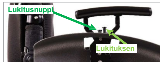
Kuva 146: Vapautuskahva oikealla (vapautuskahva on lukittu)
