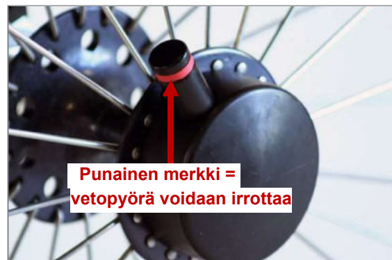
Kuva 54: Tetra Clip, jossa pikavapautusakseli on avattu; vetopyörä voidaan irrottaa
