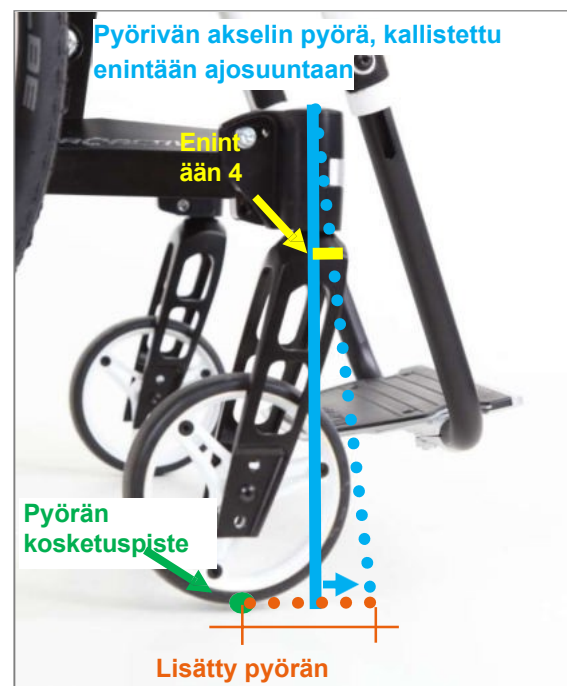
Kuva 73: Pyörän akselin kallistuksen avulla pidennetty pyörän pituus
