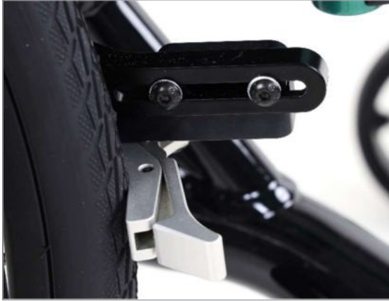
Kuva 135: Renkaalle nojaava jarruelementti
