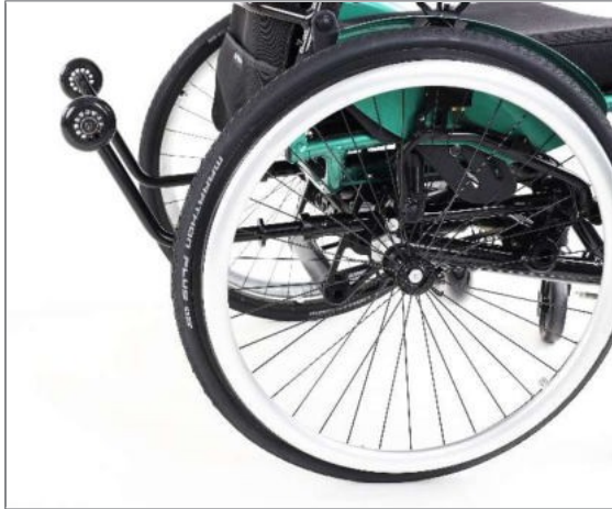
Kuva 109: Kaatumisenestotuen passiivinen asento (sivulta katsottuna)
