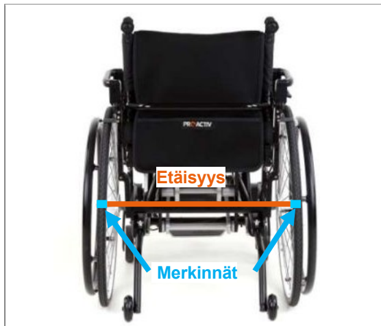
Kuva 56: Renkaiden merkintöjen välinen etäisyys (akselin korkeudella), (näkyvä takaa; LIFT kiinteä)
