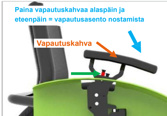
Kuva 147: Vapautuskahva noston vapautusasennossa
