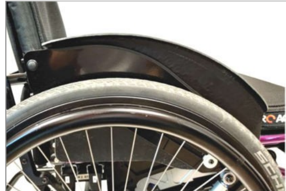
Kuva 44: Tuotteeseen asennettu vaatesuoja (näkyvä vetopyörän puolelta)
