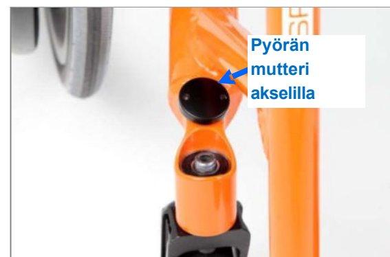
Kuva 77: Pyörän akselin mutteri on irrotettu kokonaan
