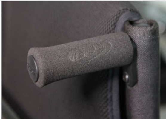
Kuva 139: Työntökahvat, vaakasuoraan takaputkeen kiinnitetyt
