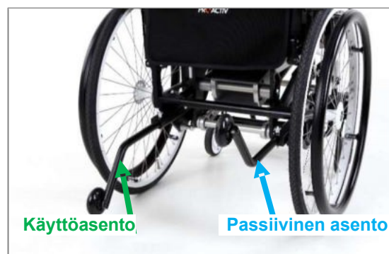
Kuva 116: Kaatumisenestotuen käyttö- ja passiivinen asento (näkyä takaa)
