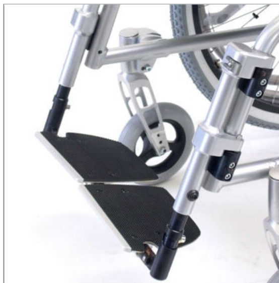
Kuva 101: Kääntyvä jalkatuki, vakiopositio
