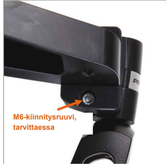
Kuva 81: M6-kiinnitysruuvi kehyksen sisäpuolella, aluslevy asennettu G-muotoisiin kehyksiin, mutta ei V-muotoisiin kehyksiin
