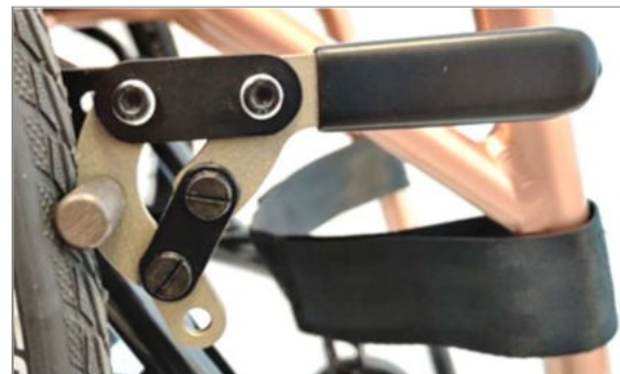
Kuva 118: Polvivivun jarrujärjestelmä vakiovarusteisella jarruvivulla
