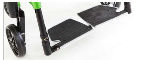
Kuva 95: Jaettu jalkatuki, vakioasento
