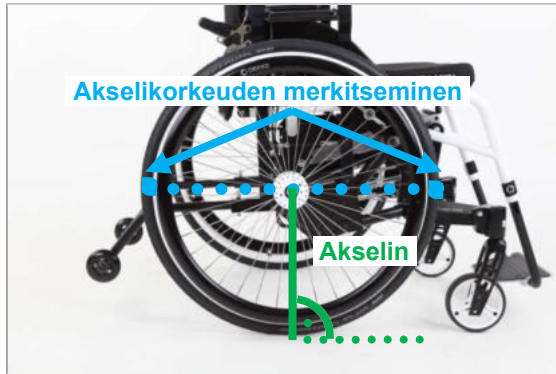
Kuva 55: Akselin korkeuden merkitseminen molempien renkaiden etu- ja takapuolelle (LIFT-merkintä)
