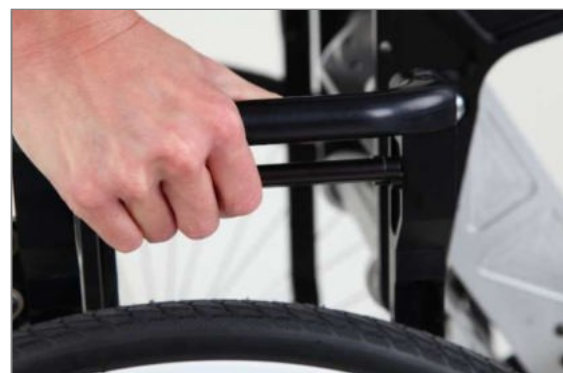
Kuva 150: Käynnistetty mekaaninen vapautusmekanismi
