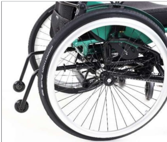
Kuva 110: Kaatumisenestotuen käyttöasento (sivulta katsottuna)
