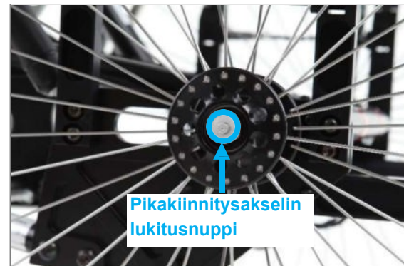
Kuva 50: Pikavapautusakselin lukitusnuppi pyörän akselin keskellä
