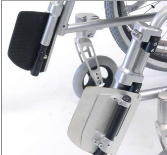
Kuva 102: Molemmat jalkatuen osat taitettuina ylös ja käännettyinä ulospäin
