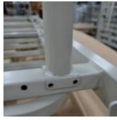
Kuva 22 – Sängyn rungon kiinnittäminen jalkoihin.
