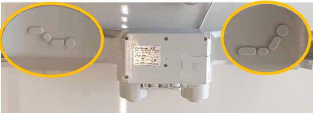
Kuva 10 – Keskimoottorin kiinnittäminen sängyn alustaan: Jalkatuki (vasen) ja selkänoja (oikea).
